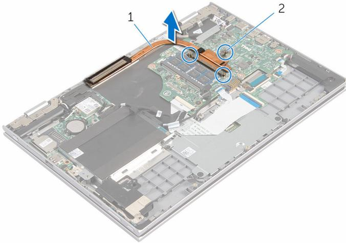
**1** dissipatore di calore
